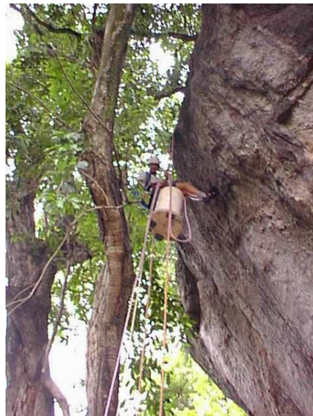
Preparação para o lançamento do vaso. A corda à direita (com folga) receberá o impacto.
